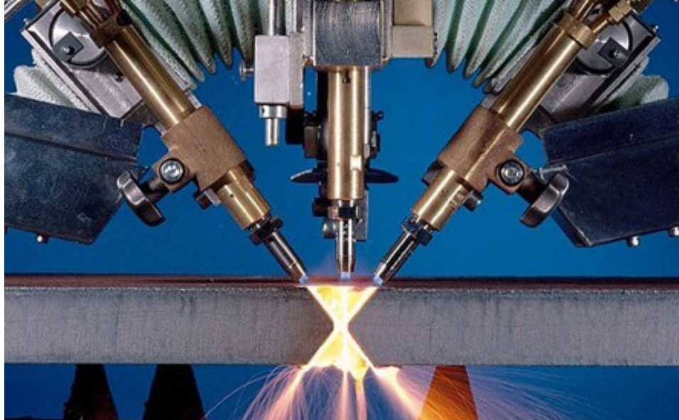
Hoe nauwkeuriger de snijkwaliteit, hoe dichter de montage van de stukken zal aanleunen bij de vooropgestelde lasnaadvoorbereiding
