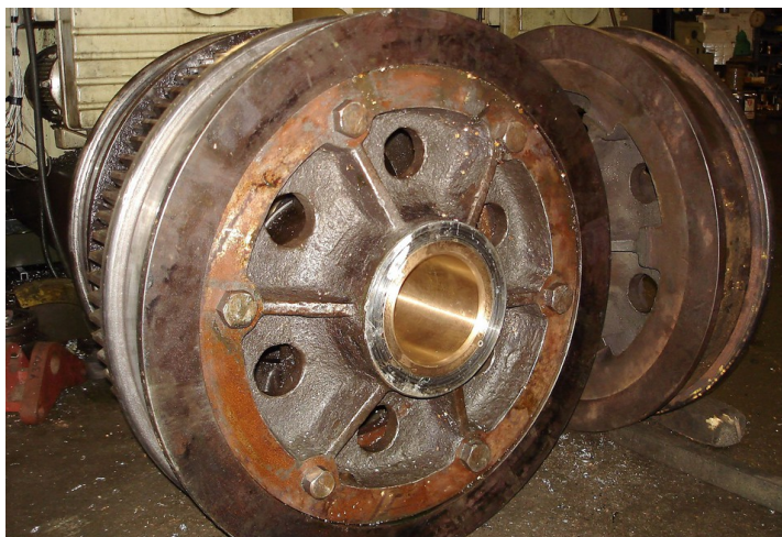
Een kraanwiel leent zich goed tot restauratielassen
