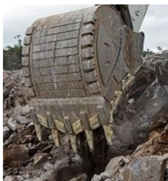
Een schepbak van een graafmachine heeft met name af te rekenen met slijtage die het gevolg is van abrasie en impact
